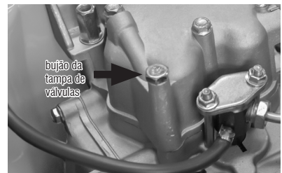
Fig. 12 – Bujão das válvulas
